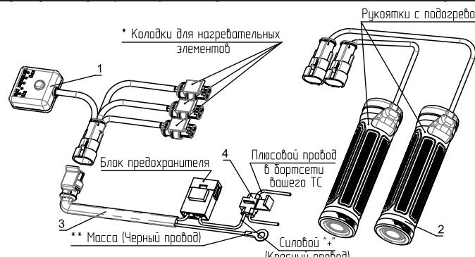
\*Данный терморегулятор имеет три вывода для однорежимных (двухвыводных) нагревательных элементов.
